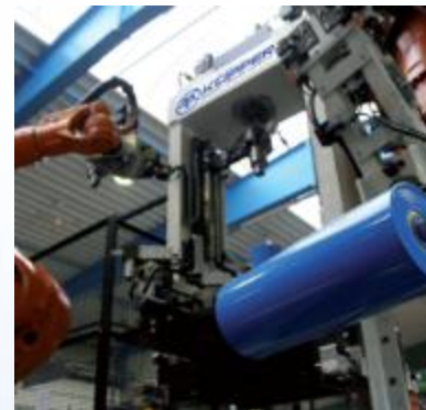
Montaža i kontrolisanje rolni
